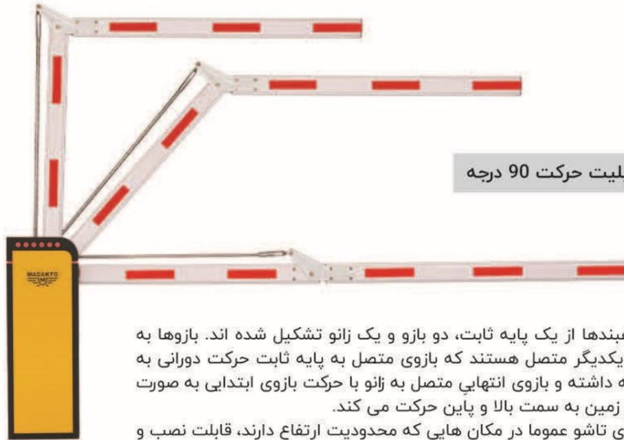
این مدل از راهبندها از یک پایه ثابت، دو بازو و یک زانو تشکیل شده اند. بازوها به وسیله زانو به یکدیگر متصل هستند که بازوی متصل به پایه ثابت حرکت دورانی به صورت 90 درجه داشته و بازوی انتهایی متصل به زانو با حرکت بازوی ابتدایی به صورت موازی با سطح زمین به سمت بالا و پایین حرکت می‌کند. این نوع بازوهای تاشو عموماً در مکان‌هایی که محدودیت ارتفاع دارند، قابلیت نصب و استفاده دارند. مانند: پارکینگ‌های طبقاتی
